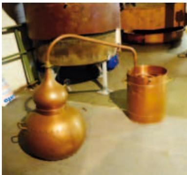
Eine typische Destillationsapparatur zur nochmaligen Reinigung der ätherischen Öle aus Latsche, Tanne oder Fichte.
